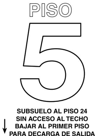
FIGURA A.7.2.2.5.4 Ejemplo de un cartel de señalización de una escalera.
